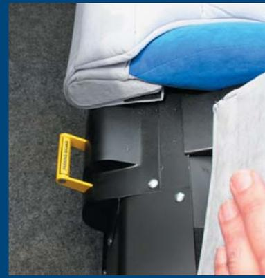
La maneta tipo lever del freno de páking; si la ves desde la posición de piloto, está frenado.
