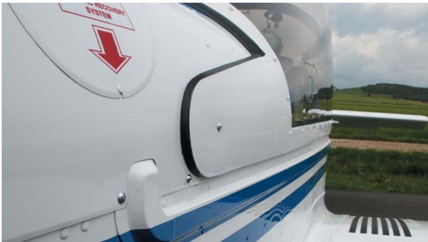
En esta toma se puede ver la posición del paracídas balístico y también que sus atalajes recorren la cabina por la parte exterior hasta el anclaje en el arco de seguridad.
