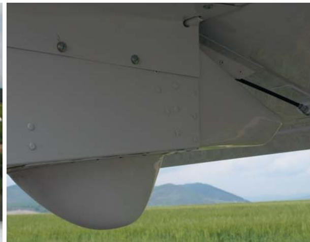
Detalle de la parte final del fuselaje en la que se observa el protector de cola y el mando actuador del compensador de profundidad.
