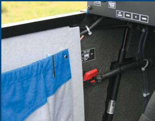
Detalle en el que se aprecian los bolsillos guardamapas, la llave de gasolina y el amortiguador que acciona la cúpula, encastrado en el aislamiento de cabina.
